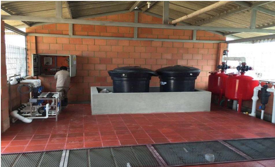
Fig. 2 Filtrado e inyección programada de fertilizantes
